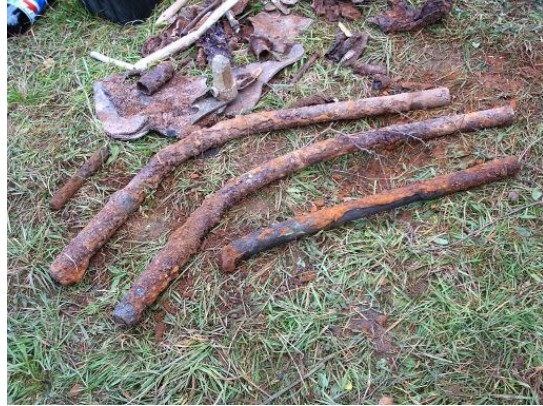
Drei Rohre der 20-mm-Bordkanonen. Bei zweien befanden sich noch die Geschosse im Patronenlager (Die Beseitigung durch den zuständigen Kampfmittelräumdienst wurde veranlasst.)
